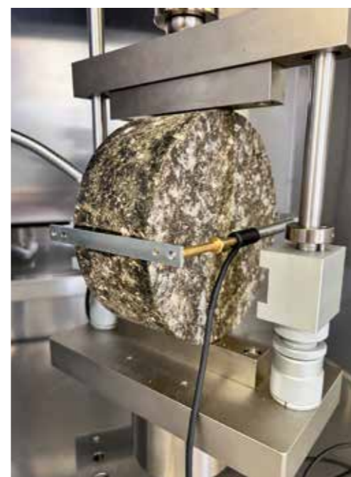
Prova a fatica ITFT.
