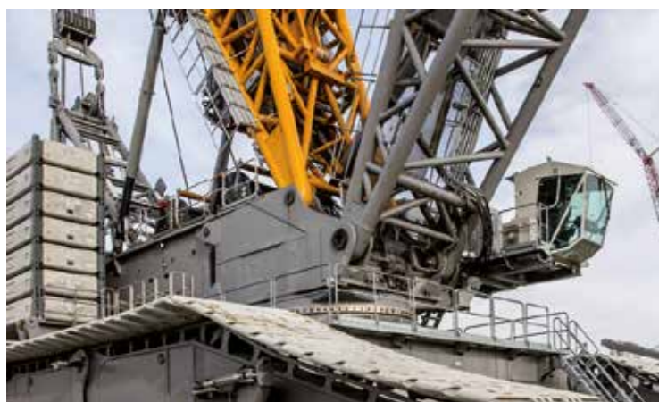
La gru cingolata LR 13000 Liebherr impiegata da Fagioli.
